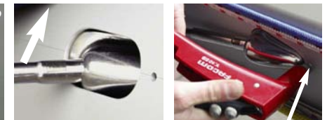
fixation d'un rivet de sécurité
